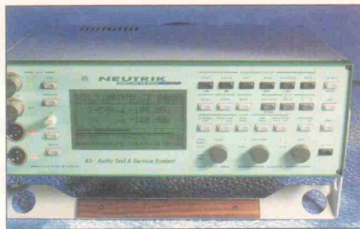
Bild 1. Trotz umfangreicher Ausstattung leicht zu bedienen: Das universelle Audio-meßsystem A2 von Neutrik.
